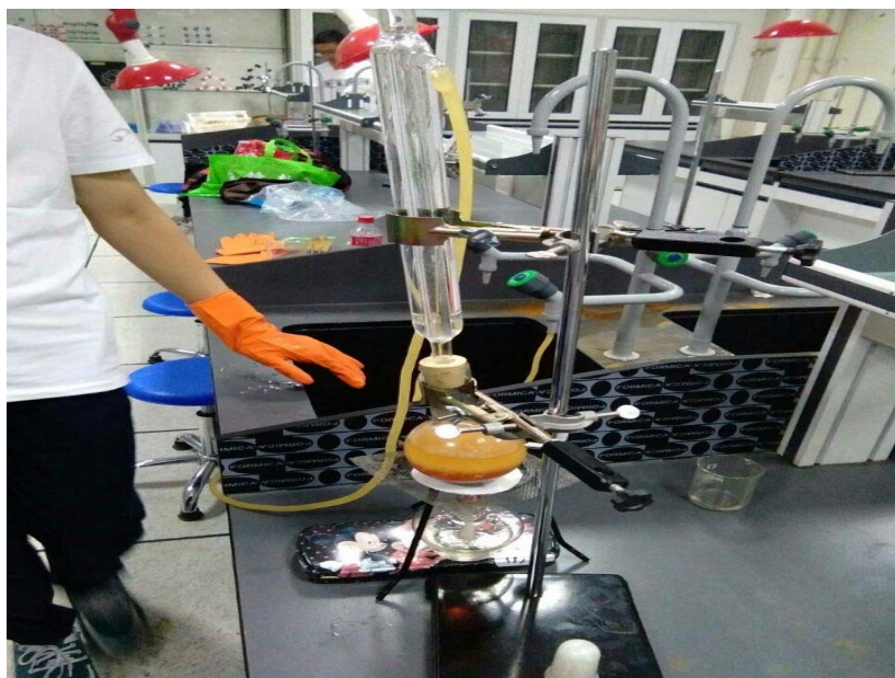
图 3-1 酯化反应装置
