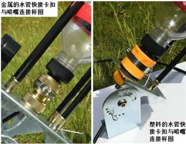
图 13 水管快速接头与喷嘴连接图示，金属接头和塑料接头两种材料。
