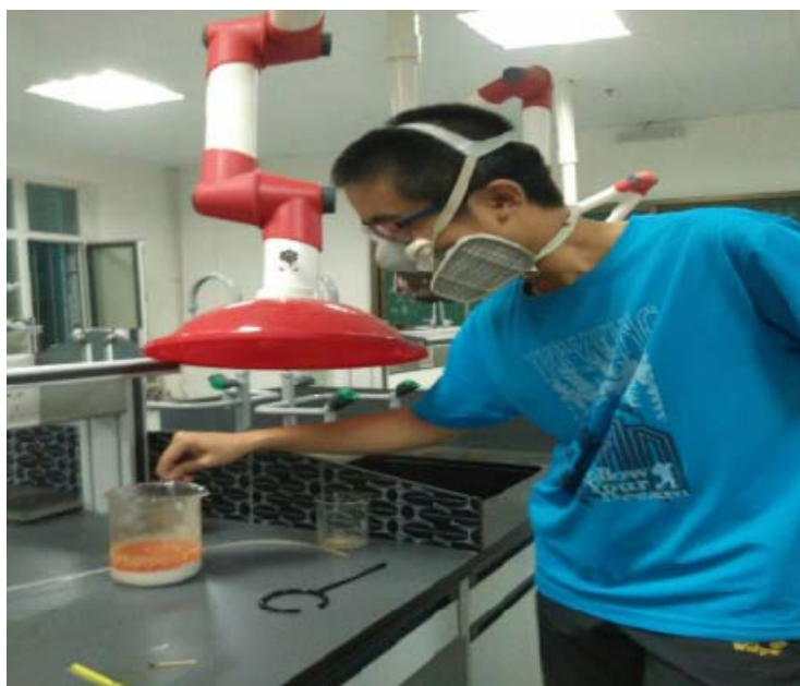
图 2-1 硝化时有二氧化氮气体逸出，所以防护要周全。
