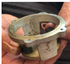
图 2-5 电刷和电刷架
