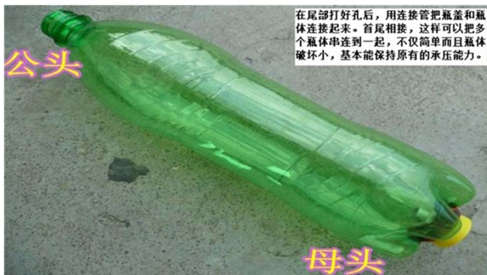
图 8 在瓶尾钻好孔后，用连接器把瓶盖和瓶体连接好
