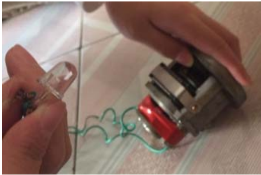
图 2-6 将发电机接入电路
